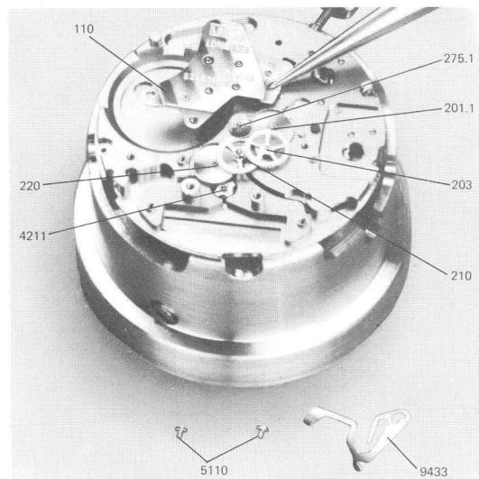
8.4.8 Vérifier les ébats des mobiles qui doivent être compris entre 0,03 et 0,05 mm. Pour mesurer l'ébat du rotor, le pousser vers le haut puis vers le bas, avec des brucelles non magnétiques, son aimant le maintenant normalement dans une position d'équilibre intermédiaire.
